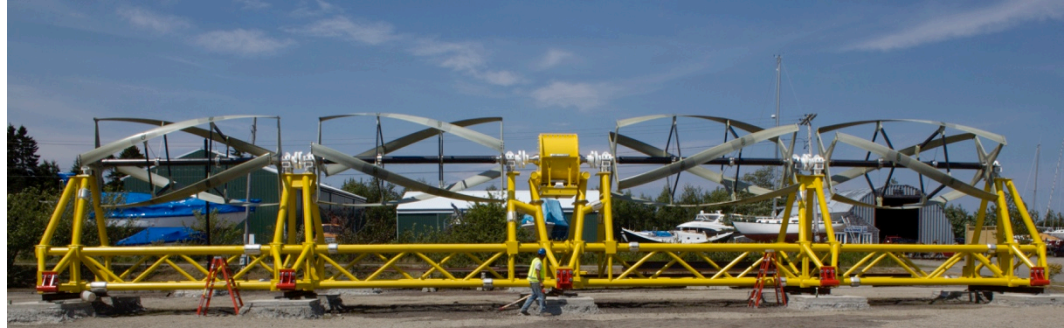
Figure E-3. ORPC TidGen Tidal Generator
